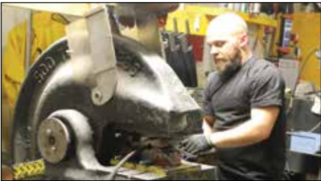
Marc-André, un employé de l’entreprise, a fait une démonstration d’épissure sur câble d’acier afin de donner aux invités un aperçu des techniques utilisées par les Industries Lam-é.
