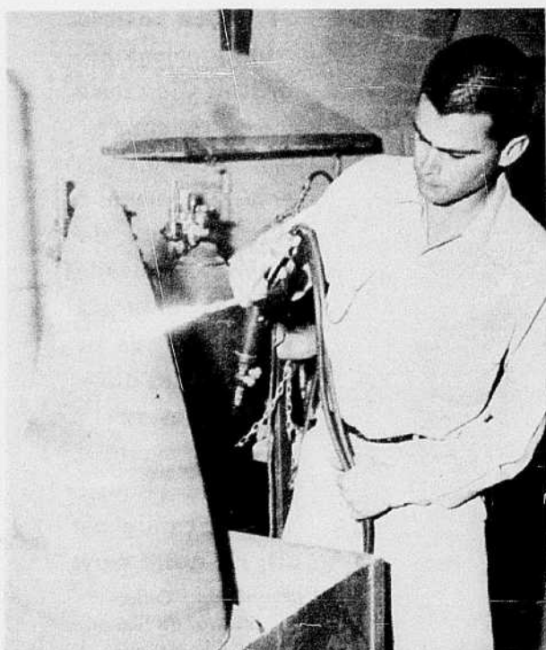
La céramique vaporisée sur le cône de cette roquette est d'environ 5.000 degrés Fahrenheit. Attention à qui la répand ! L'opération se déroule à Los Angeles.
