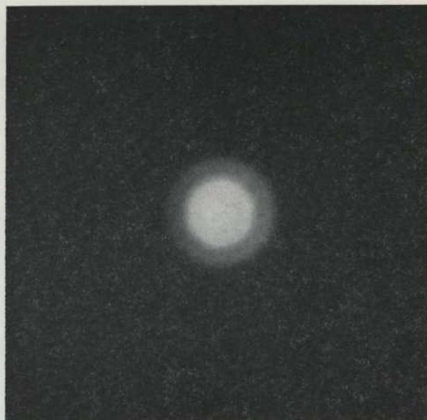
Fig. 2. Figure de diffraction du \text{C Cl}_4 à l'état gazeux (tétrachlorure de carbone). Cette figure a été obtenue en faisant passer un faisceau d'électrons à travers du tétrachlorure de carbone. Sur cette photo, quelques anneaux seulement sont visibles; le centre de la photo marque le point d'arrivée des électrons qui ne sont pas entrés en collision avec le \text{C Cl}_4 .
