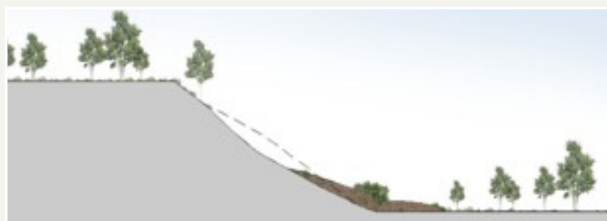
Figure 2 : L'aléa (glissement de terrain)
