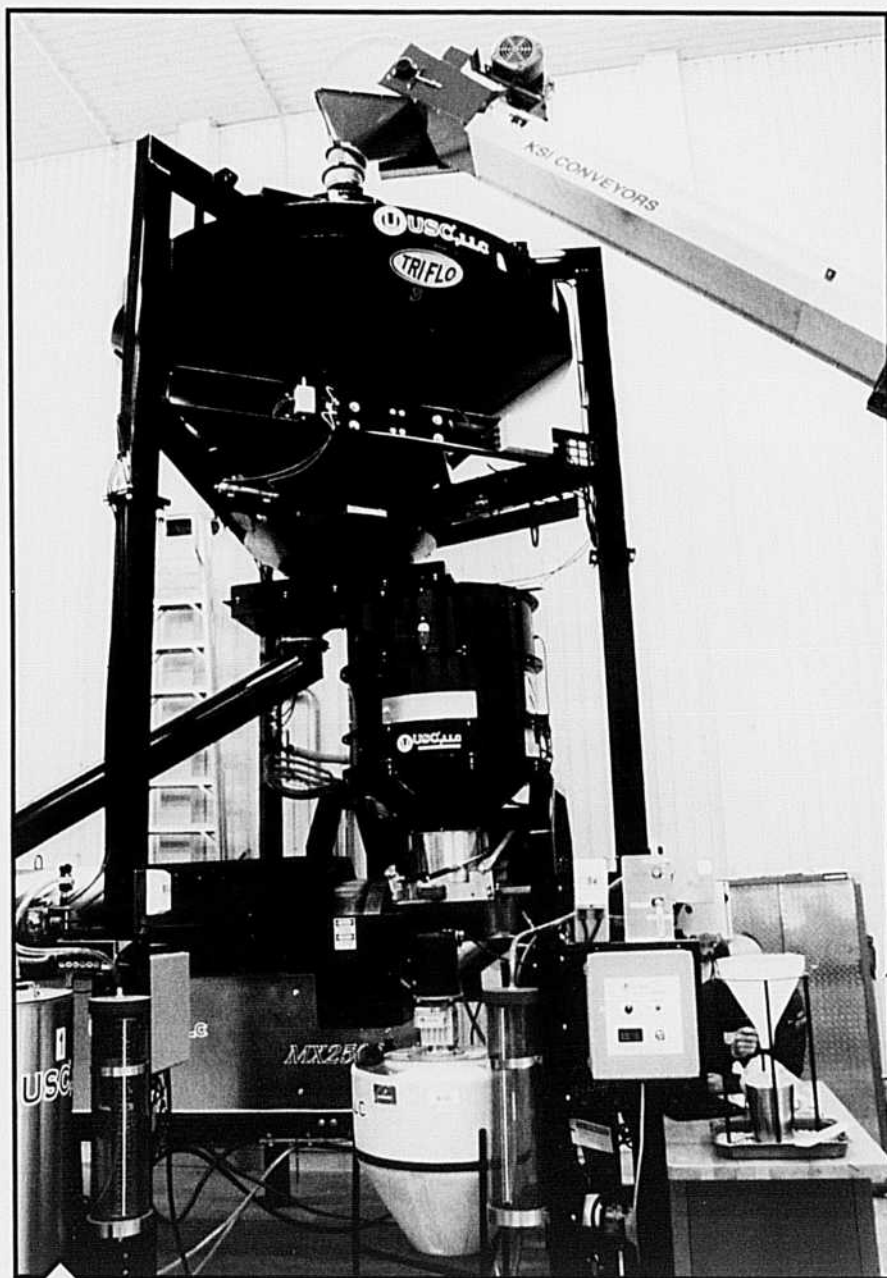
Le système de traitement et d'inoculation de la semence sur place permet de choisir l'une ou l'autre de ces opérations ou même de n'utiliser aucun additif.
