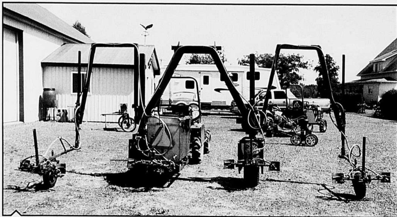
L'arroseuse fabriquée par le patenteux permet de traiter quatre rangs de sapins simultanément.
