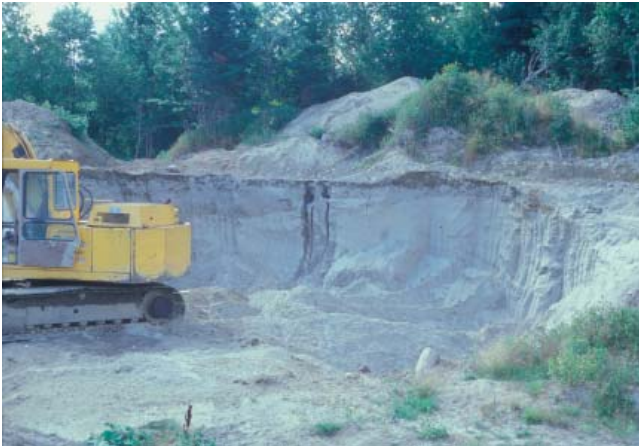
PHOTO 13 - Face de 2 à 4 m de hauteur constituée de sable moyen à fin (banc 59, gisement 27).
