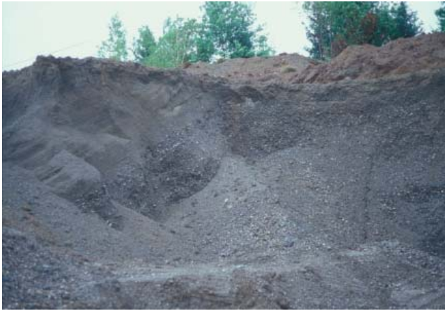
PHOTO 7 - Face de 4 à 6 m de hauteur composée de sable moyen à grossier et légèrement graveleux reposant sur du gravier (50 à 60 %). On peut voir des stratifications obliques typiques d'une sédimentation deltaïque (banc 37, gisement 16).
