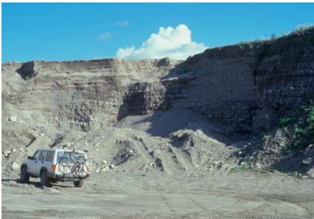
PHOTO 17 - Face fraîche de 7 à 8 m de hauteur composée de sable moyen à grossier interstratifié de gravier avec, par endroits, quelques cailloux. La proportion de gravier varie de 10 à 50 % (banc 61, gisement 31).
