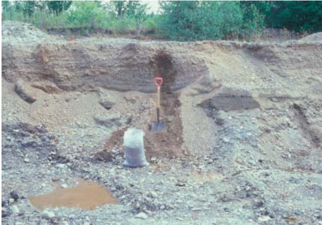
PHOTO 1 - Coupe de 2 m de hauteur composée de sable moyen stratifié avec des interlits de gravier totalisant entre 10 et 35 % (banc 1, gisement 1).
