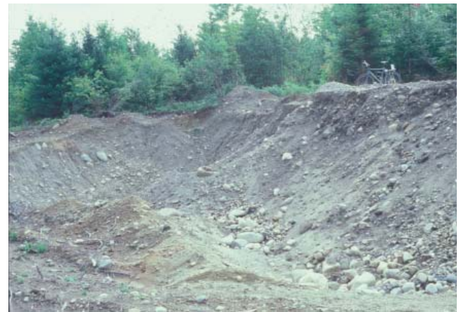
PHOTO 16 - Coupe de 3 à 5 m de hauteur formée surtout de sable moyen avec 20 à 40 % de gravier et 5 à 10 % de cailloux (banc 64, gisement 29).
