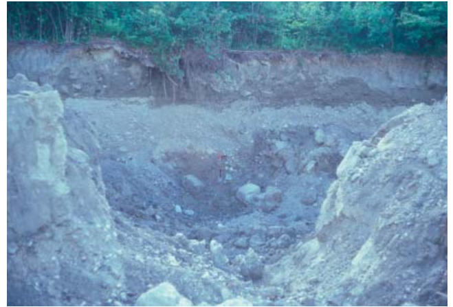
PHOTO 14 - Face de 3 à 4 m de hauteur composée de gravier (30 à 50 %) avec quelques cailloux soutenus par une matrice sableuse sans structure (banc 59, gisement 27).
