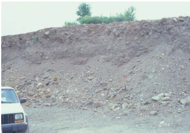
PHOTO 3 - Coupe de 4 à 5 m de hauteur composée de gravier (40 à 60 %) et de cailloux (5 à 15 %) soutenus par une matrice sableuse sans structure (banc 11, gisement 2).
