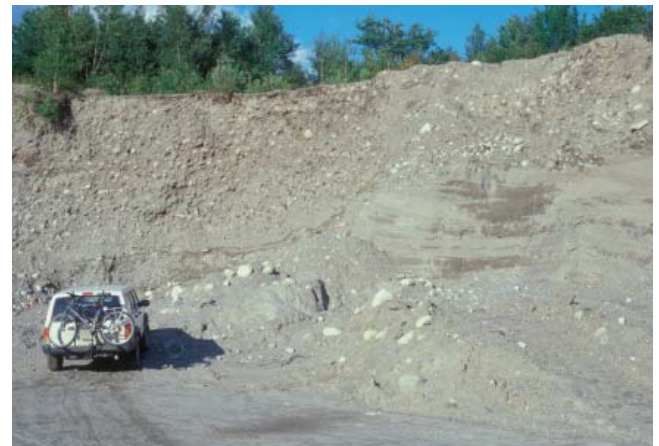
PHOTO 18 - Coupe de 6 à 8 m de hauteur où la granulométrie des matériaux est très variable. La stratification passe de bonne à fruste et une zone de sable moyen à grossier stratifié côtoie une zone de gravier (50 à 70 %) et de cailloux (15 à 30 %) soutenus par une matrice sableuse sans structure (banc 61, gisement 31).
