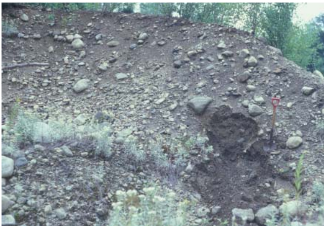
PHOTO 15 - Face de 3 à 5 m de hauteur constituée de 50 à 60 % de gravier et de 10 à 20 % de cailloux soutenus par une matrice sableuse sans structure (banc 77, gisement 28).
