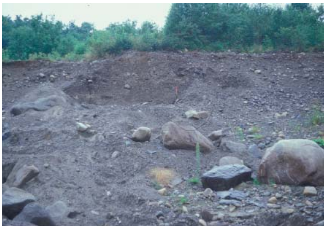
PHOTO 21 - Face de 3 à 4 m de hauteur composée de gravier (40 à 60 %) avec des cailloux (5 à 15 %) et quelques blocs soutenus par une matrice sableuse à sablo-silteuse sans structure. Ce banc constitue une bonne source pour produire des matériaux concassés (banc 75, gisement 33).
