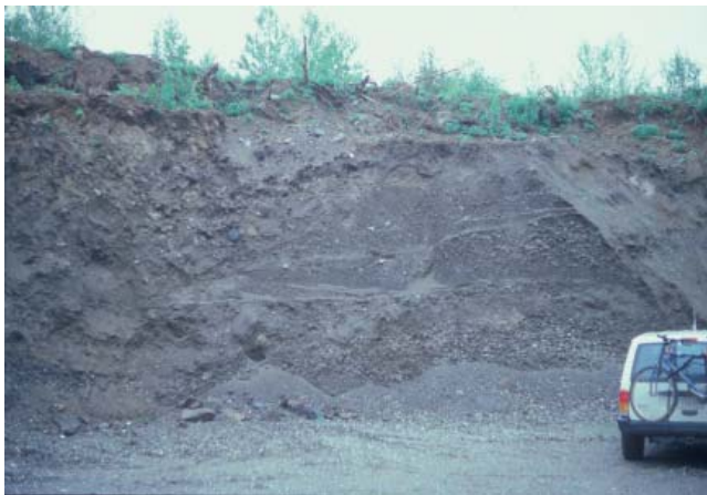
PHOTO 9 - Face de 4 à 5 m de hauteur montrant des variations brusques dans la granulométrie et la stratification. Les matériaux passent d'un gravier (40 à 60 %) avec cailloux soutenus par une matrice sableuse sans structure à du sable moyen à grossier propre avec du gravier plus ou moins bien stratifié (banc 40, gisement 17).
