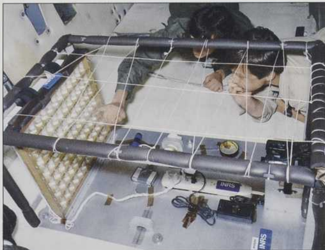
Dans l'avion orbital, François Quirion, à gauche, examine les 84 mélanges liquide-air dont il testera le comportement en apesanteur.
