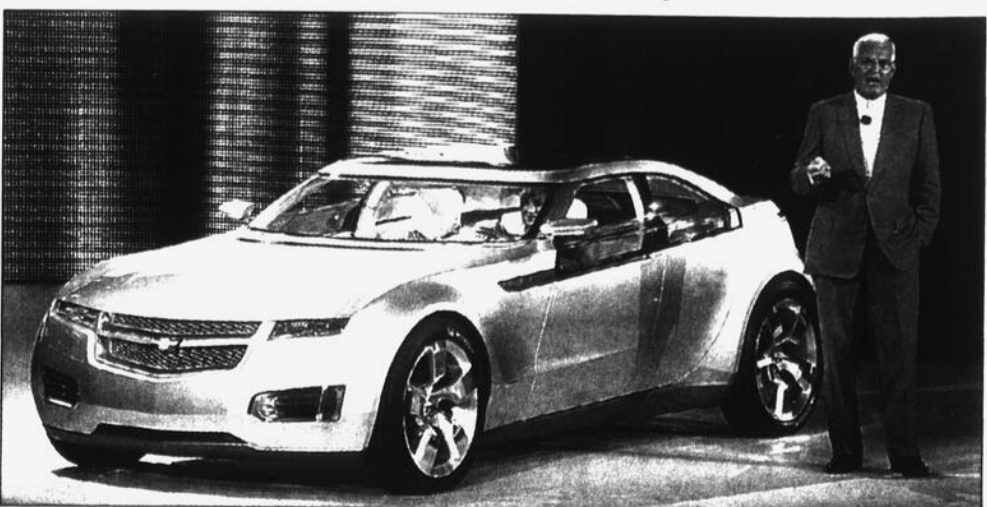
La Chevrolet Volt est une voiture électrique à piles rechargeables qui peut parcourir 60 km avant de tomber en panne! Pour recharger les batteries, il suffit de la brancher comme un appareil électroménager ou de rouler grâce à un petit moteur 3 cylindres turbo qui devient alors un système hybride. La consommation est de 2,8 litres aux 100 km.
