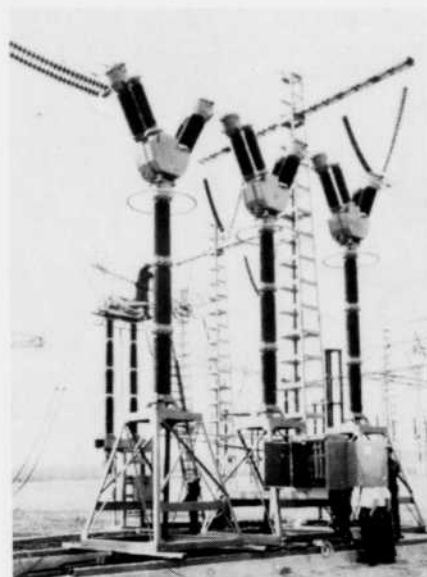
Pôle de disjoncteur « orthoprojecteur rapide » à petit volume d'huile, à six coupures en série, type OR 6K - 420 kV - 12,000 MVA — en essai au poste de Creney d'Electricité de France.
