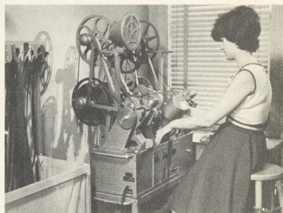
Le travail de montage à l'aide de la moviola, petit appareil de projection individuel qui permet de visionner le film à travers une lentille grossissante ou sur un écran miniature en verre dépoli. On contrôle en même temps le son par le passage de la piste sonore devant un lecteur muni d'un amplificateur.
