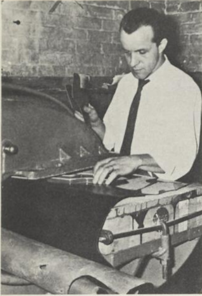
La coupe à l'emporte-pièce est mécanisée mais demande cependant de la part de l'ouvrier un coup d'oeil précis.
