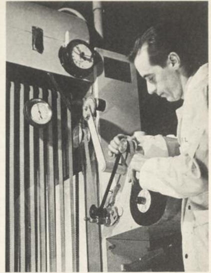
◀ Réducteur Debris. Cet appareil sert à reproduire par projection optique image et son de films 35 mm. sur des pellicules de 16.
