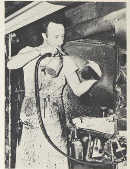
A l'aide d'un fusil on vaporise l'apprêt qui donnera le lustre indispensable pour une présentation impeccable.
