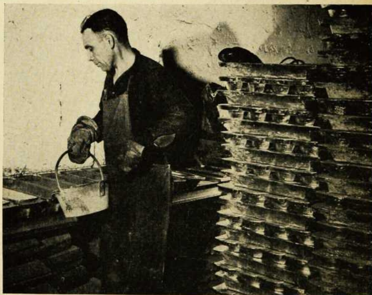
Dans une usine de raffinage de Montréal on coule, dans des moules, du plomb récupéré de vieux accumulateurs d'auto, de vieux tuyaux, de presse-papiers, etc. Ce plomb entrera dans la fabrication des avions, des corvettes, des obus.
