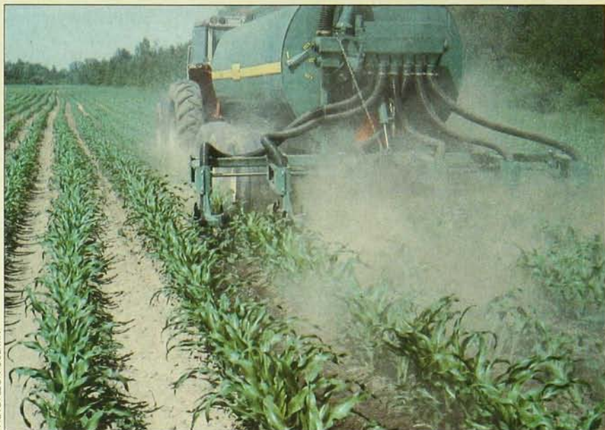
Un épandeur à lisier de 13,8 tonnes équipé de 6 injecteurs espacés de 75 cm doit parcourir 767 mètres pour épandre 40 tonnes à l'hectare.
