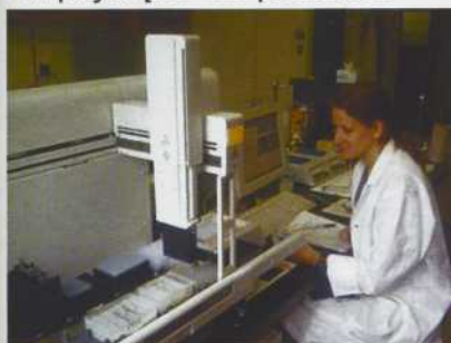
Criblage d'une banque d'enzymes améliorées à l'aide d'une station robotisée. Appareillage de type FPLC permettant de purifier les enzymes.
