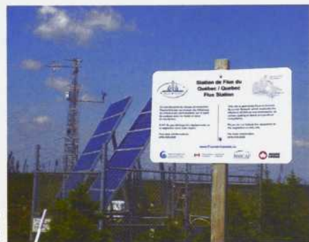
Une des stations de Fluxnet, dans la réserve faunique Asuapmushuan. Station équipée d'appareils informatisés montés sur des pylônes en forêt pour enregistrer l'échange de dioxyde de carbone, de vapeur d'eau et d'énergie, et pour déterminer ce qui est produit et fixé par les plantes et par les arbres.
