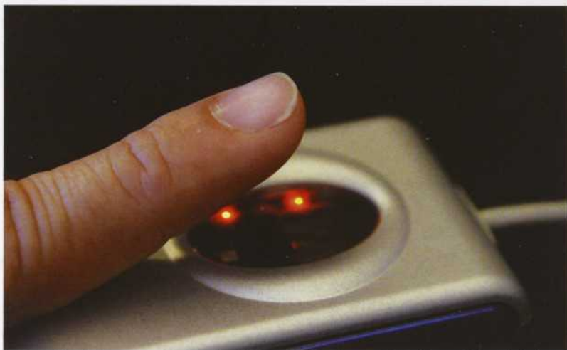
Lecture d'un index sur un clavier biométrique à l'aide d'un capteur d'empreintes digitales.
