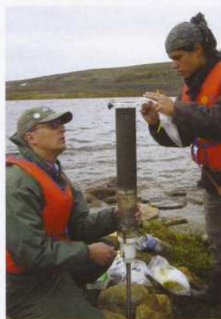
Échantillonnage des sédiments lacustres.
