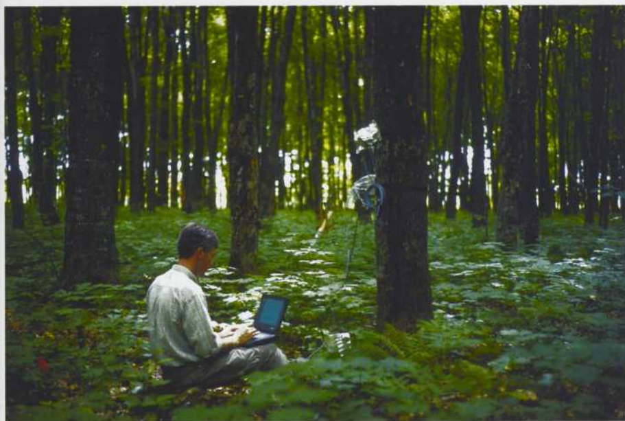
Mesure de la transpiration d'un arbre.
