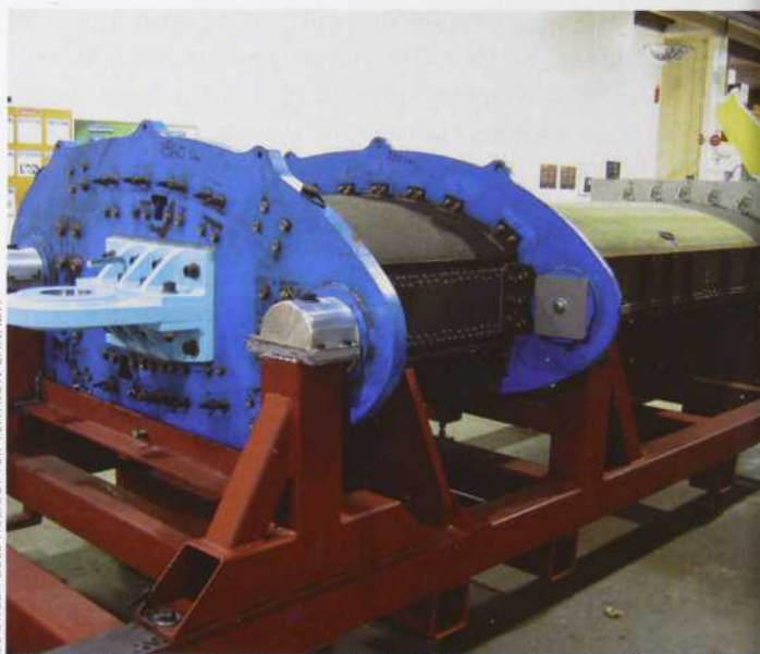
Résultat d'un des projets de recherche du CRIAQ, ce caisson de voilure d'aile tout composite a été fabriqué par la méthode de moulage par transfert de résine. L'assemblage illustré permettra d'effectuer une batterie de tests de résistance avec divers chargements, en simulant les conditions de vol les plus critiques.
