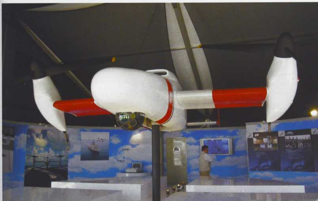
Avion de surveillance sans pilote (UAV) Eagle Eye de Bell Helicopter Textron. Les hélices sont orientables pour permettre un décollage vertical, comme avec l'hélicoptère, puis un vol horizontal comme un avion régulier; l'avion est presque entièrement fait de composite. Photo prise au Salon du Bourget en France en juin 2005.
