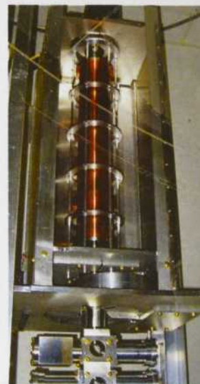
Cœur de l'horloge atomique au centre de son écran magnétique.
