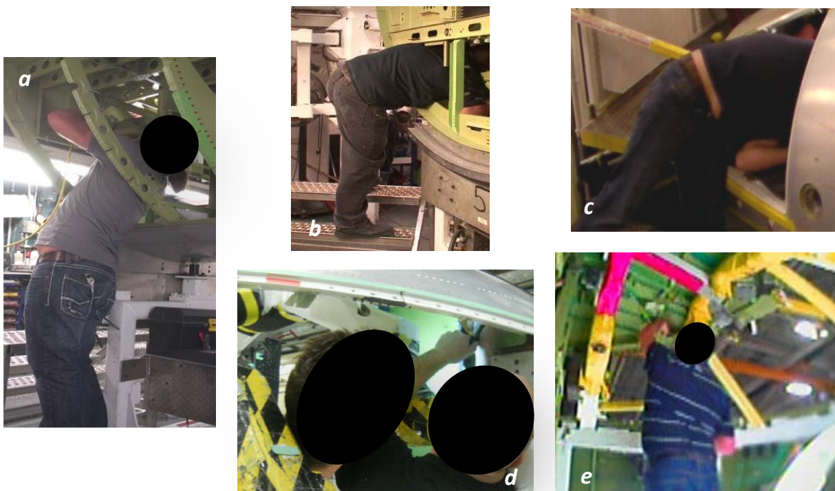
a. b. et c. contraintes d'espace impliquant des contraintes posturales aux stations 3 et 4 ; d. manque de visibilité à la station 2 ; e. travail exigeant pour les membres supérieurs à la station 1
