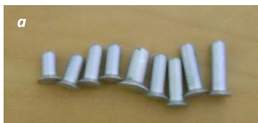
a. rivets de taille variée; b. rivets dans leur boîte de transport au poste; c. Hi-lite (rivets vissés)
