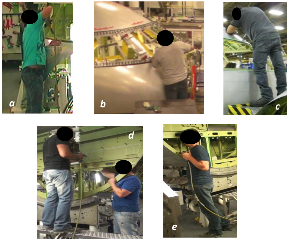
a. et b. perçage aux stations 1 et 2 ; c. fraisage à la station 2 ; d. et e. rivetage à deux et seul à la station 4
