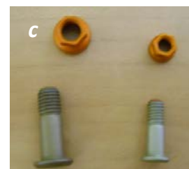
a. rivets de taille variée; b. rivets dans leur boîte de transport au poste; c. Hi-lite (rivets vissés)
