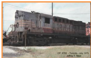
Montreal Locomotive Works CP 8793 RS-18u (No. série 82474) construite en 07-1958 et reconstruite au CP-Angus à 1828 en 1985 -
