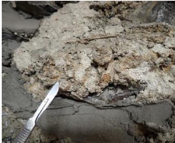
Photo 4 : échantillon n° 1.5, avec fragments de bois, fondation du mur du retable, côté de la sacristie
