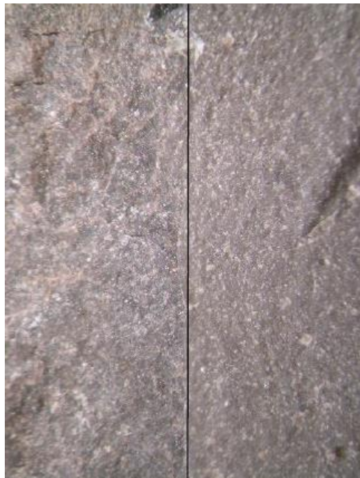
Photo 16 : échantillons de pierre du plancher (gauche) et calcaire de Beauport (droite) au microscope
