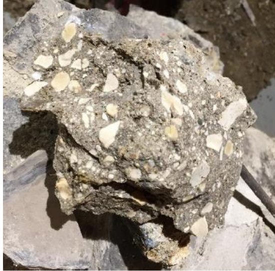
Photo 7 : mortier de pose prélevé (n os 3.7 et 3.7a) à l'intérieur du muret (humide)
