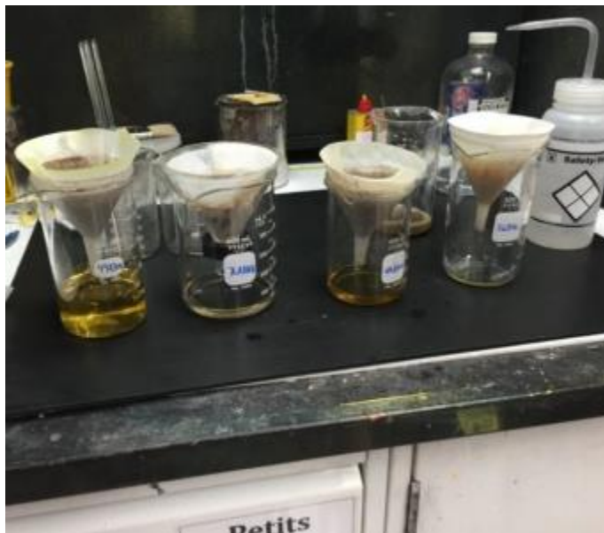
Photo 20 : digestion acide en cours de réalisation
