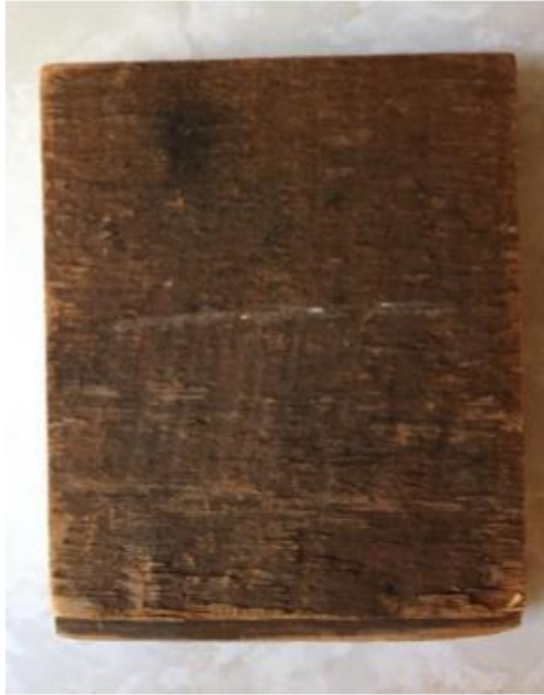
Photo 27 : marques de sciage irrégulières et légèrement inclinées sur la section de bois retirée
