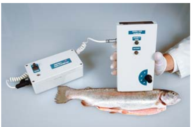
Figure 2.5 : Mesure de la teneur en lipides de la chair d'un poisson au moyen d'un appareil (« Torry fish fatmeter »)
