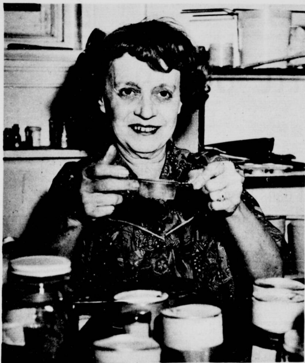
◁ Mme Yvette Gouin, émailleuse. La voici posant sur une pièce de cuivre la première poudre, celle qui formera le fond avant la cuisson préliminaire. La poudre de verre passe à travers un fin tamis.
