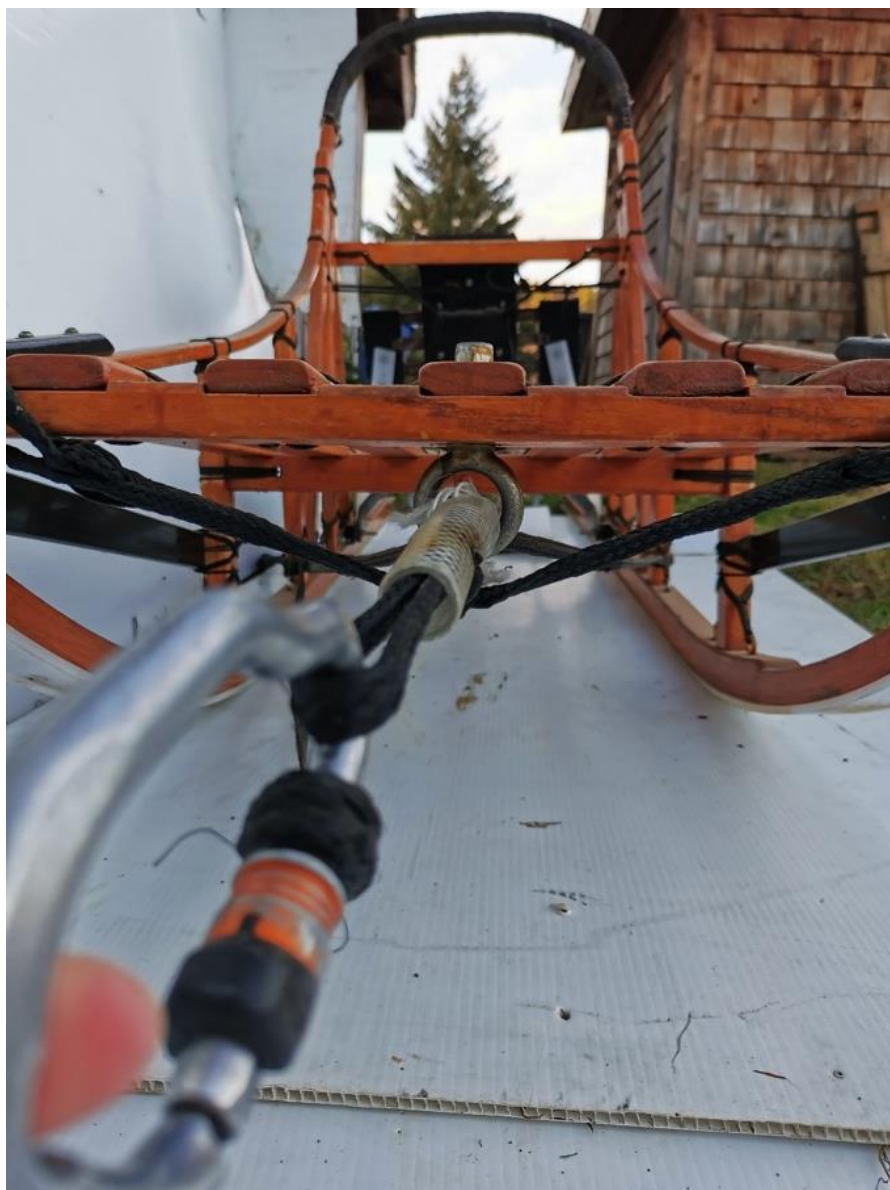
Figure 40 : Attache de la ligne au traîneau
