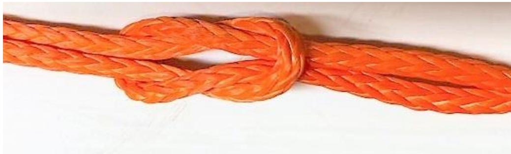
Figure 48 : Nœud pour relier deux sections de ligne
