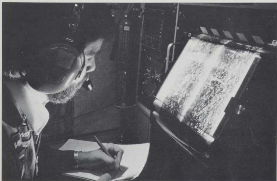
Installé à bord d'un avion Dash-7 d'Environnement Canada, le radar SLAR-100 de la compagnie CAL d'Ottawa est utilisé pour l'observation des glaces en temps réel.
