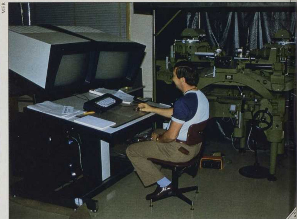
Les photographies aériennes (1) sont soumises à un restituteur analytique (2). Reliefs, cours d'eau, réseaux routiers s'enregistrent dans l'ordinateur en couches superposées. À l'écran, qui se subdivise, on peut observer quatre niveaux différents en même temps (3).
