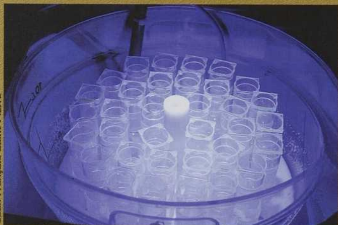
Deufs de morue sous un simulateur solaire
