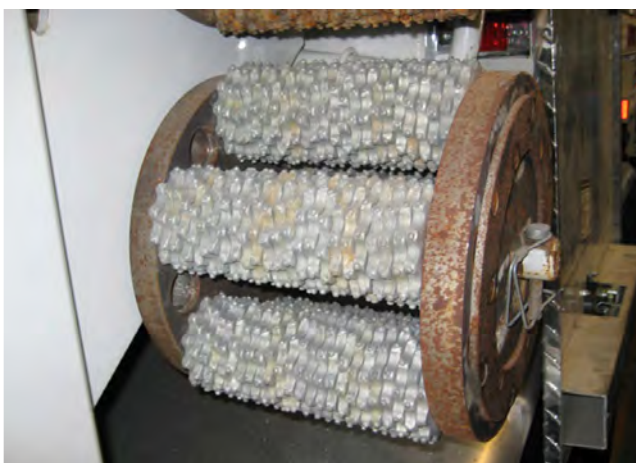
Figure 65 – Montage des lames pour l'effacement par abrasion
