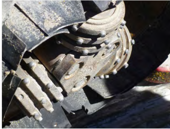
Figure 67 – Lames sous un effaceur manuel
