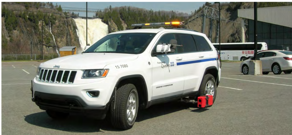
Figure 51 – Rétroreflectomètre mobile monté sur un véhicule
