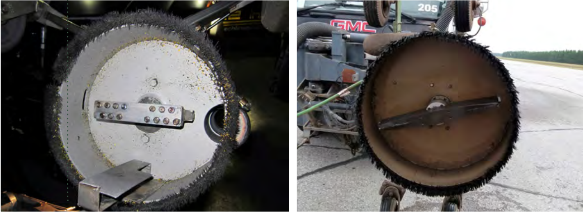
Figure 71 – Têtes avec buses pour l'eau sous haute pression
