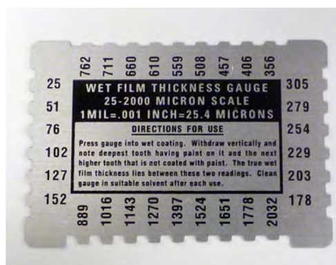
Figure 25 – Jauge d'épaisseur ( \mu\text{m} )
