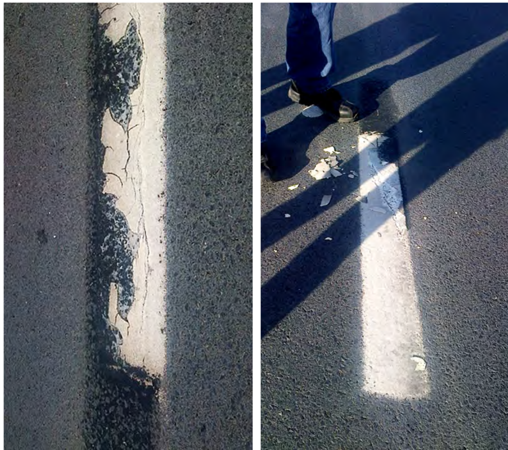
Figure 62 – Application d'un produit à base de résine époxydique sur un produit non durci
