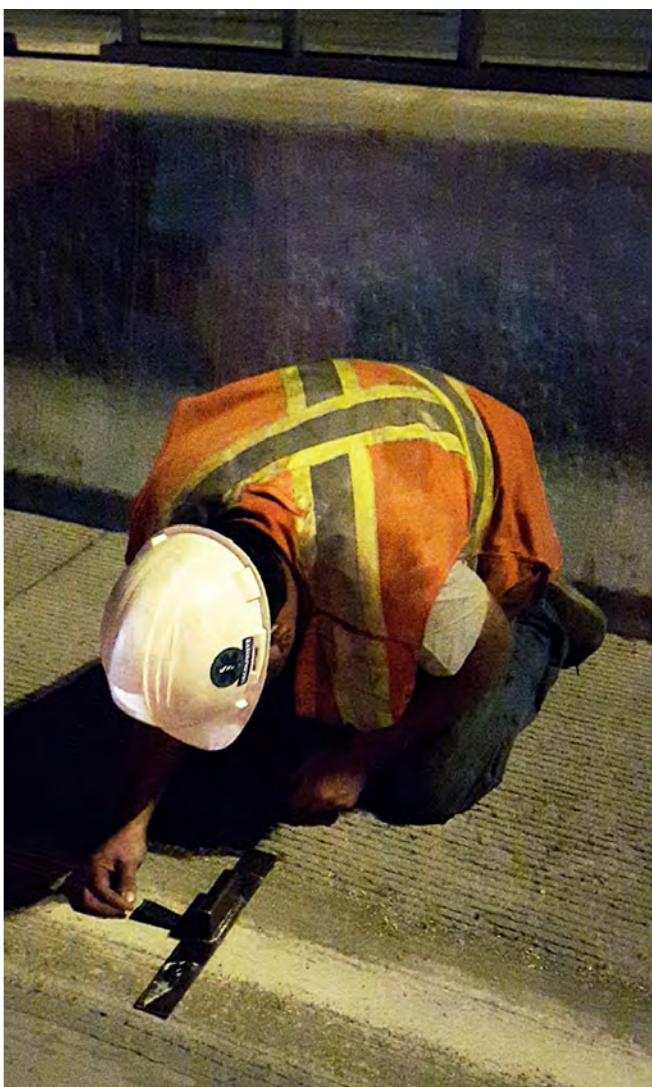
Figure 36 – Exemple de mesure avec la jauge conique
