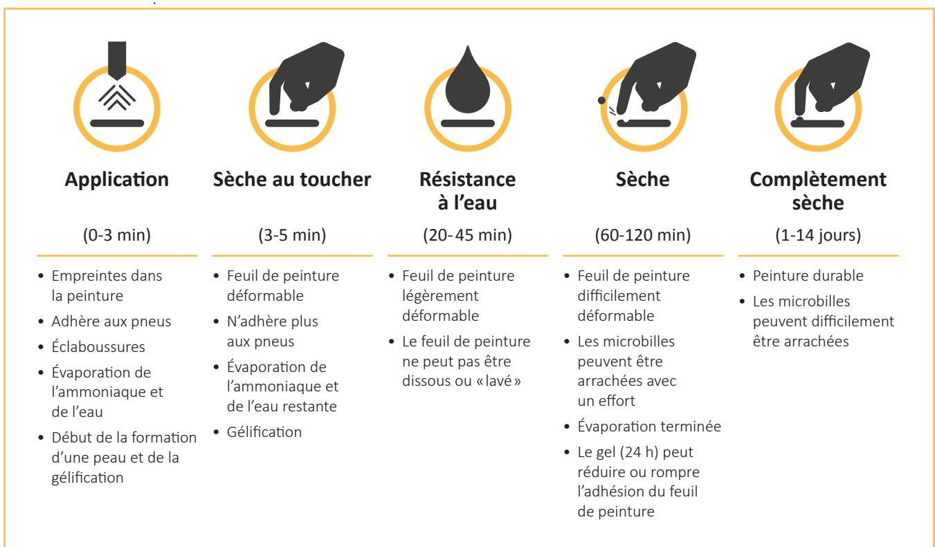
Figure 15 – Processus du temps de séchage de la peinture à base d'eau
