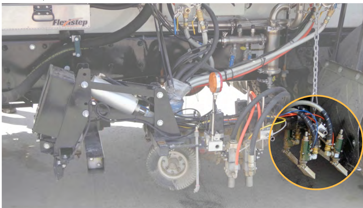
Figure 45 – Exemple de fusils applicateurs de microbilles de verre
