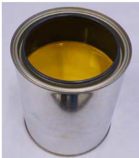
Figure 18 – Exemple de contenant insuffisamment rempli
