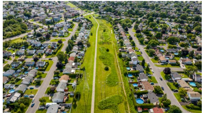
Figure 4 : Aménagement d'une prairie comprenant des herbacées et de petits arbustes dans une emprise de ligne de transport, misant sur une gestion différenciée de la végétation
