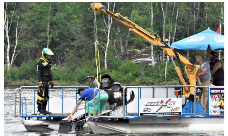
Les motoneiges noyées sont tirées hors de l'eau grâce à un treuil puis asséchées. Elles sont prêtes à repartir en moins de dix minutes.
