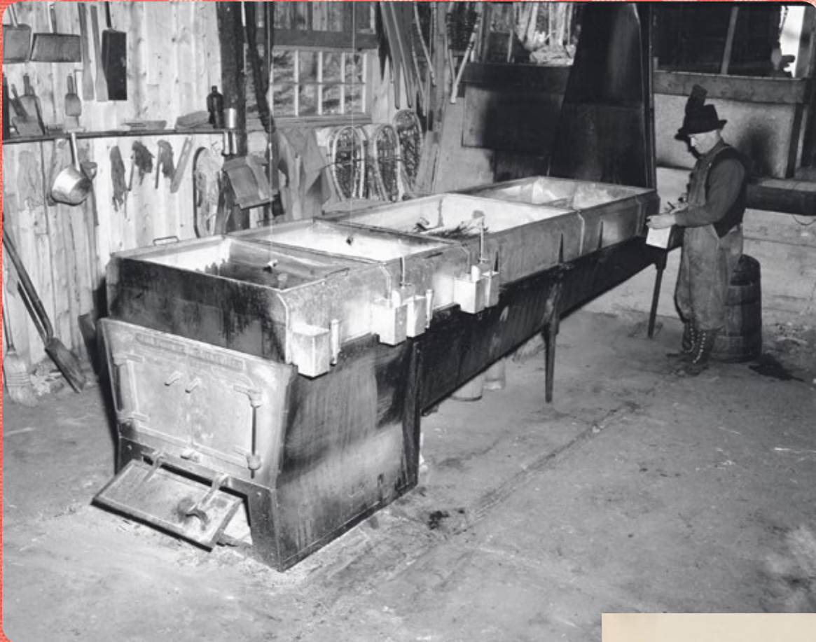
Évaporateur de la cabane à sucre de Philippe Nadeau, Sainte-Marie-de-Beauce, 1950. Archives nationales à Québec, fonds Ministère de la Culture et des Communications (E6, S7, SS1, D2, P75913).
