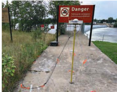
Installée sur trépied parfaitement nivelé, une antenne capte des signaux de GPS provenant des satellites qu'elle transmet à la boîte noire qui collecte l'information. (Photos : Jean-Christophe Noël)
