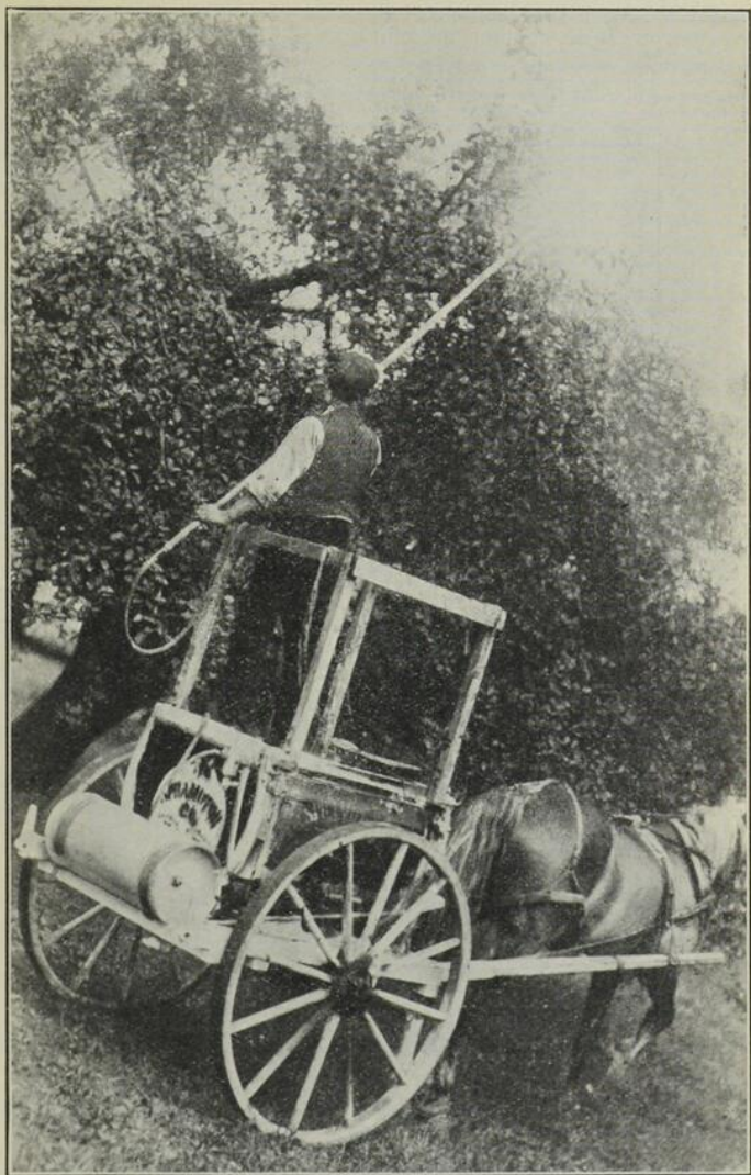
Fig. 100.—Même dans les pentes du verger, on peut arroser les pommiers. Pulvérisateur "Sparamotor" à un cheval pour petits vergers.
