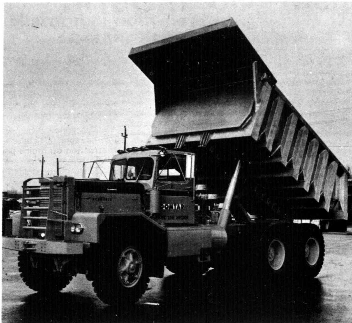
APRES AVOIR TRANSPORTE en trois ans plus aluminium de ce camion est encore en bon état. d'un million de tonnes de pierre, la caisse en
