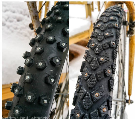
Credits : Paul Labranche À gauche, pneu Ice Spiker Pro de Schwalbe à 360 clous. À droite, pneu Marathon Winter de Schwalbe à 240 clous.
