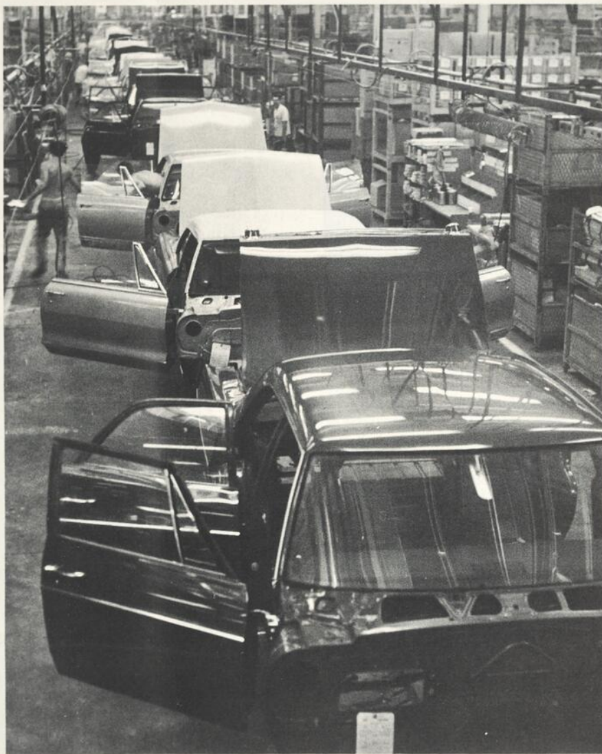
Parvenues à la section des garnitures et menus accessoires, ces autos GM reçoivent leurs pare-brise et glaces, serrures, moulures et parures extérieures au fur et à mesure qu'elles avancent sur la chaîne d'assemblage. Une fois posés le rembourrage et les banquettes, les carrosseries seront acheminées par pont-roulant à la section des châssis et assemblage final.
