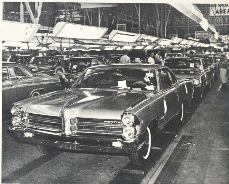
Une fois achevée, l'automobile est soumise à un examen approfondi. Chaque auto passe par 28 postes d'inspection avant la livraison.
