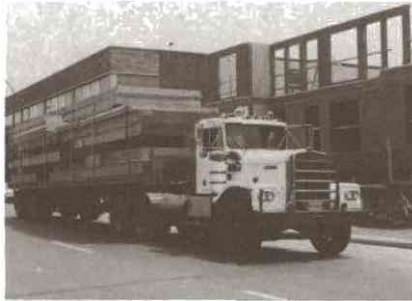
Le transport de panneaux gaufrés renfermant un isolant non rigide permet l'utilisation optimale de l'espace de chargement du véhicule.
