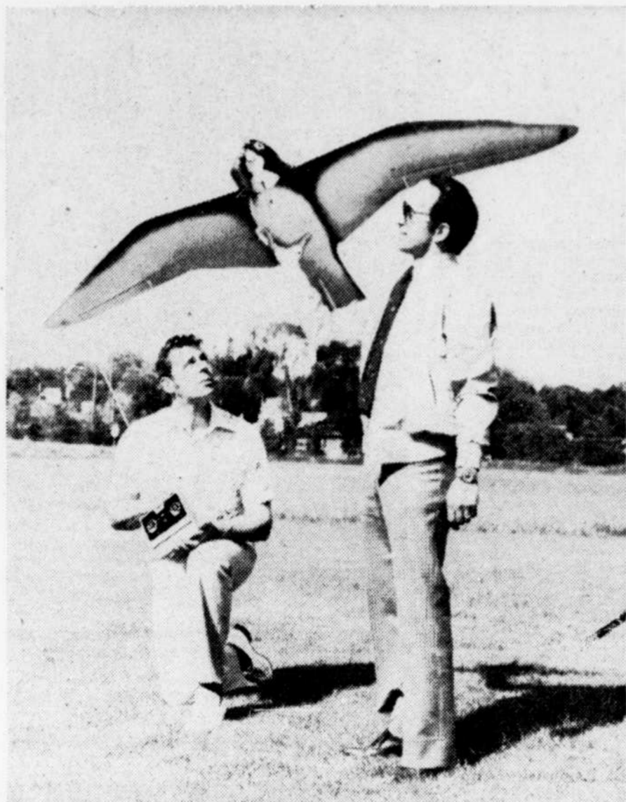
Des experts du Conseil national de recherche du Canada expérimentent le "faucon mécanique", qui pourra être utilisé au-dessus des aéroports pour effrayer les oiseaux.
