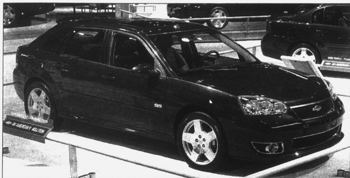
Les versions SS des modèles Malibu et Malibu Maxx proposeront de bonnes performances à un prix réaliste. Pour ce faire, un nouveau moteur V6 de série 3900 développant 240 chevaux sera couplé à une boîte semi-automatique à quatre rapports. Pour améliorer le comportement routier, des jantes de 18 pouces et une suspension sport seront à la hauteur des lettres de noblesse «SS» de Chevrolet.
