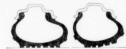
La semelle radiale touche sur toute la largeur. La semelle ordinaire ne permet qu'un contact partiel avec la route.
