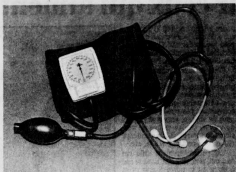
Le sphygmomanomètre ou tensiomètre rend de précieux services. Le modèle illustré fonctionne avec un stéthoscope, mais il existe de nombreux appareils numériques qui font la lecture sans stéthoscope, donc plus faciles à utiliser.
