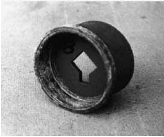
Figure 7.38 Exemple de restricteur de débit avec bouchon en plastique pour contrôle dans un puitsard.
