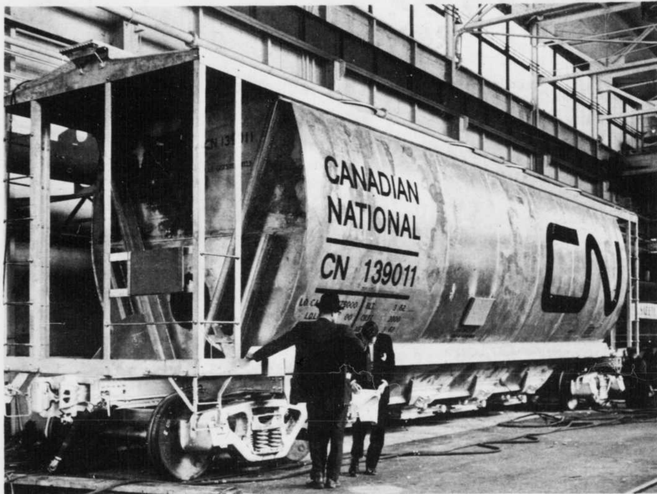
L'ALCAN a aidé à mettre au point un wagon-trémie en aluminium offrant de nombreux avantages par comparaison avec le matériel roulant de
