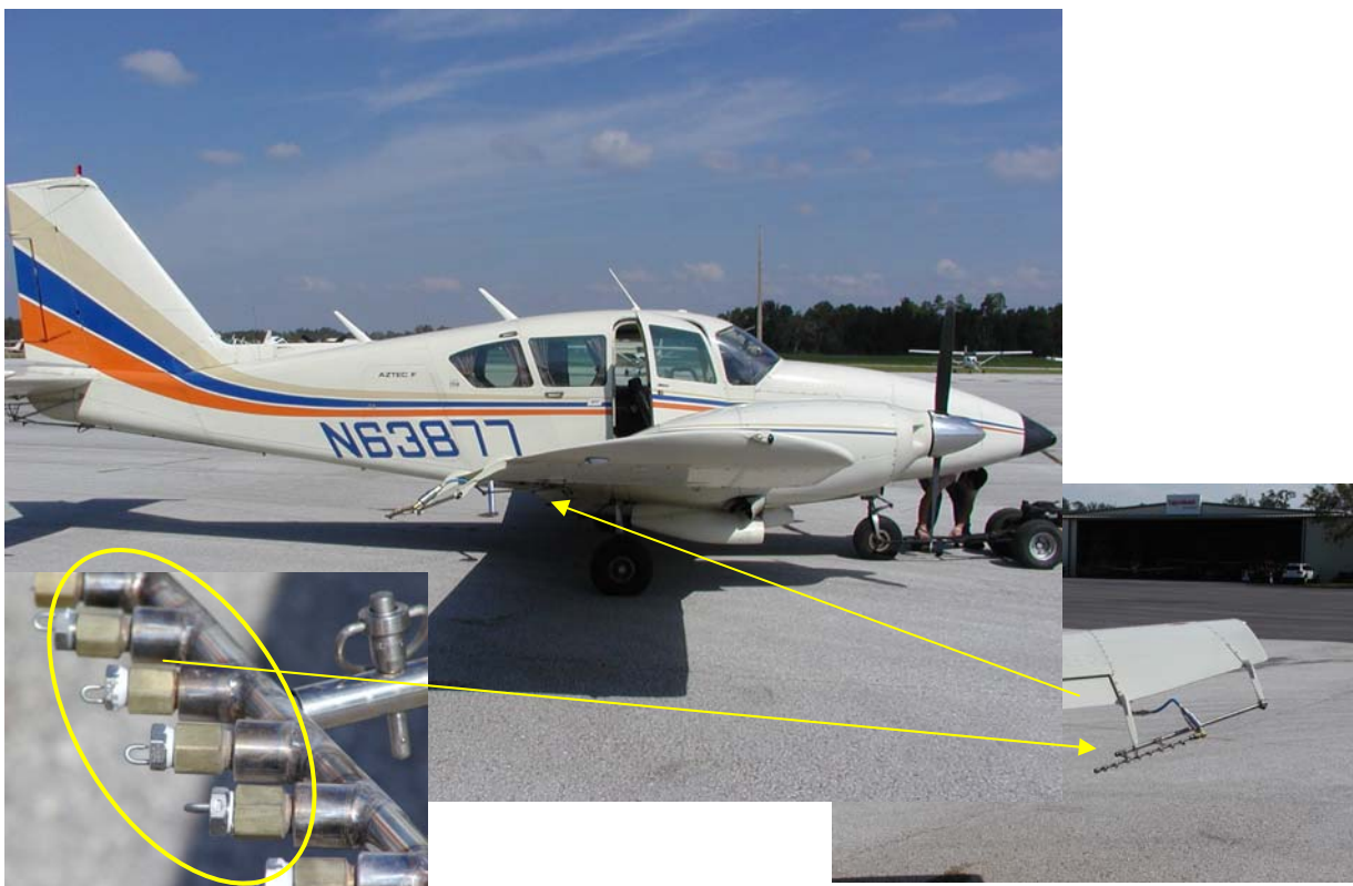
Figure 3.3 Avion Aztec du PCMCD avec buses montées sur l'aile de tribord et gros plan des 6 buses PJ20 HP
