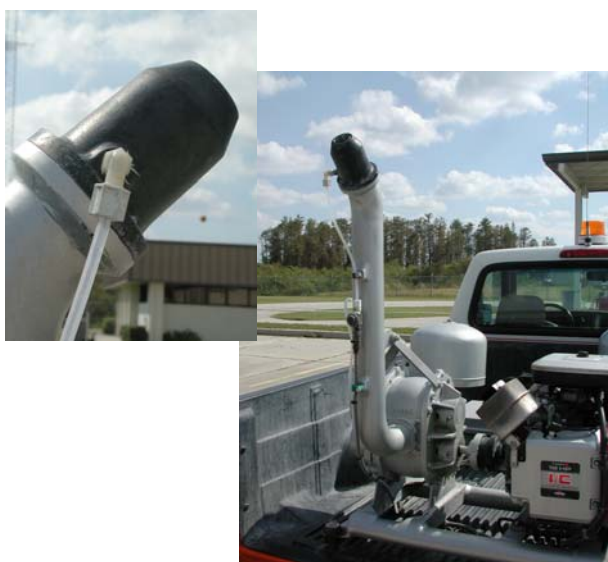
Figure 3.1 Équipement d'application terrestre avec gros plan de la buse Clarke Grizzly
