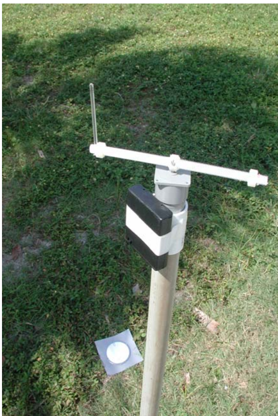
Figure 3.11 Station d'échantillonnage composée d'un système rotatif à lames d'impaction et d'un échantillonneur de dépôt au sol
