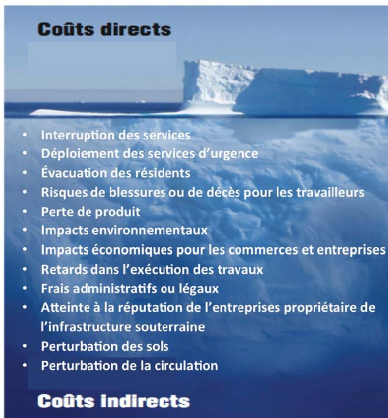
Figure 1 : Schématisation de l'ampleur des coûts indirects par rapport aux coûts directs d'un bris d'infrastructure souterraine
