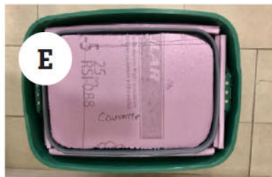
E) Isoler le dessus du petit bac.
