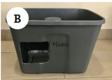
B) Faire un trou de 6 pouces de large max. sur les deux bacs et l'isolant (pas au centre).
