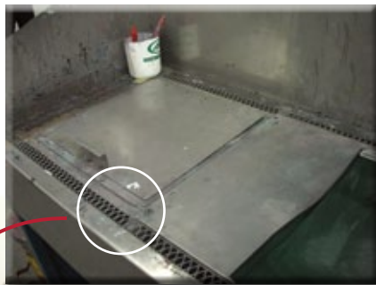
Le surplus de solvant est maintenant acheminé dans un baril via une ouverture sous la trappe.
