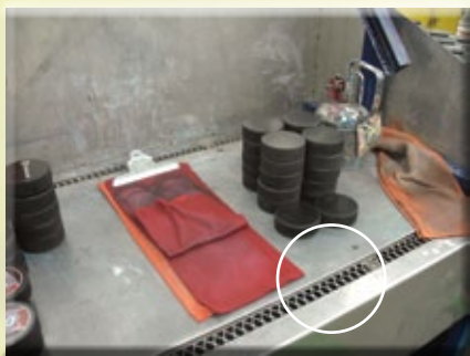
La fente sur le pourtour de la table permet d'aspirer les vapeurs de solvant à la source.
