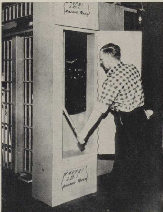
UN EXPERT VERIFIE LE CONTROLE DES PORTES DES CELLULES AVANT QU'ELLES QUITTENT L'USINE.
