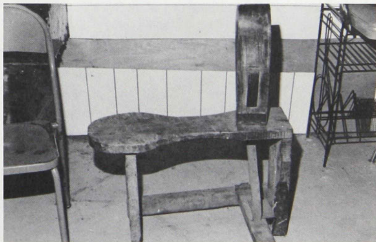
Figure 34. Le banc de sellier est un chevalet muni d'un étau de bois qu'on ajuste avec le pied.
