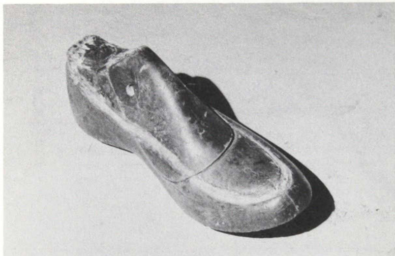
Figure 26. Forme de bois de facture industrielle, sur laquelle on monte la chaussure.
