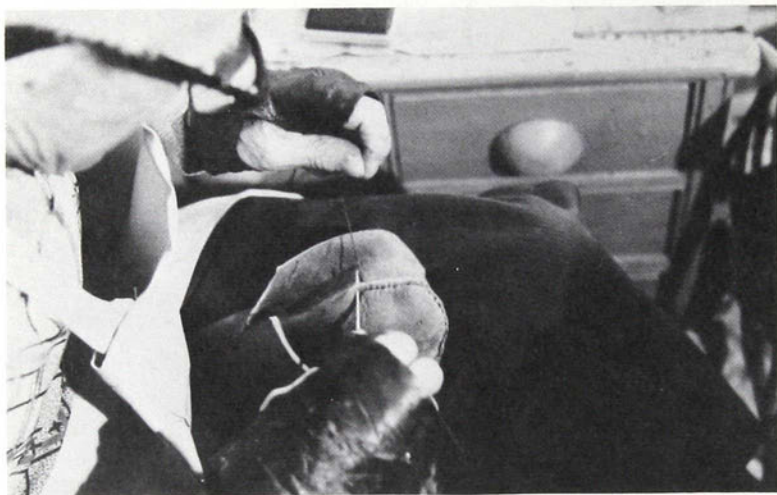
Figure 56. La forme de bois enlevée et la chaussure tournée à l'envers, on termine le cintrage arrière par une couture intérieure.
