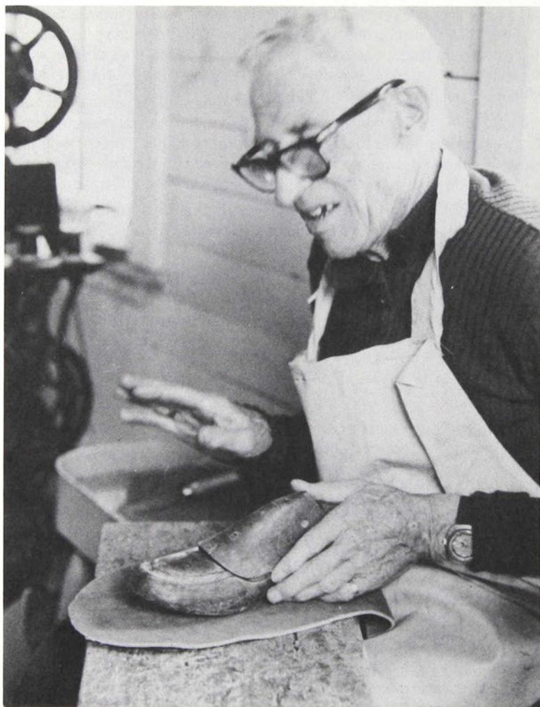
Figure 38. En posant la forme de bois sur la pièce de cuir, l'artisan procède à l'essayage afin de s'assurer que le tout a été prévu à la bonne dimension.
