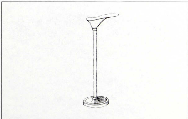
Figure 25. C'est sur un support comme celui-ci, que l'on nomme pied de fer, que le cordonnier travaillera les semelles le plus aisément.
