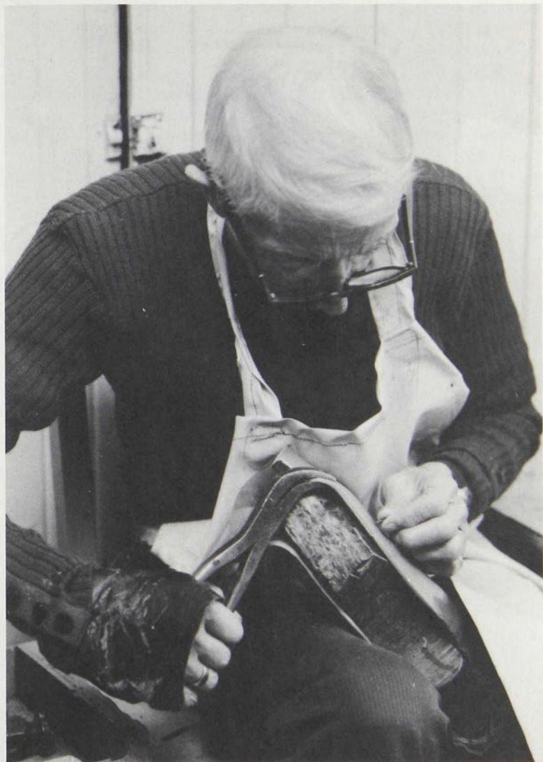
Figure 51. Avec les pinces à mâchoires courbes ou pinces à tendre, l'artisan tire le cuir vers l'arrière de la forme en prenant appui sur celle-ci.
