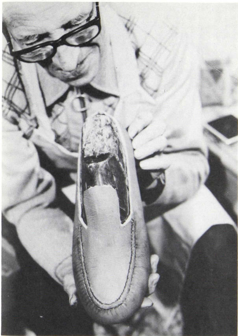
Figure 58. Une languette est découpée dans le dessus du pied et elle entrera dans une ouverture de même dimension pratiquée dans la jambe de la botte.
