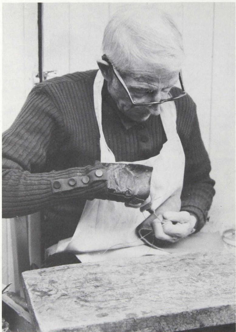
Figure 40. Avec un doigt sous la pièce de cuir, le cordonnier commence la perforation du plissage.
