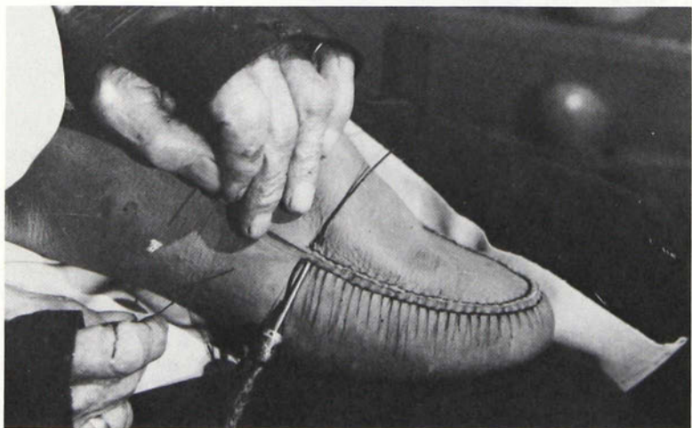
Figure 50. Pour terminer la couture, le cordonnier pratique une perforation supplémentaire en sens inverse de la couture, y fait entrer les deux brins du ligneul et les coupe avec son tranchet.
