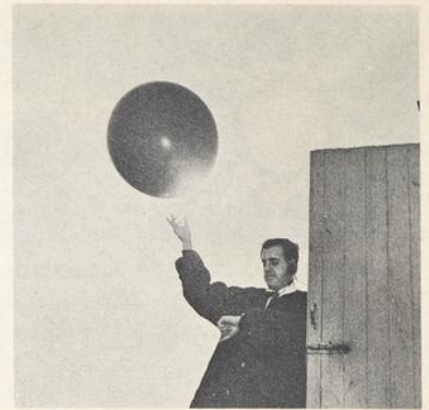
Un météorologiste lâche un ballon gonflé d'hydrogène qui sera suivi au théodolite afin de déterminer la direction et la vitesse du vent.
