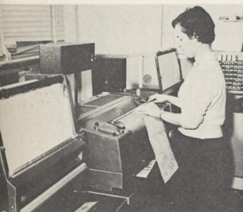
Une opératrice pose le tableau de température sur le tambour de la traceuse de carte pour une diffusion régionale.
