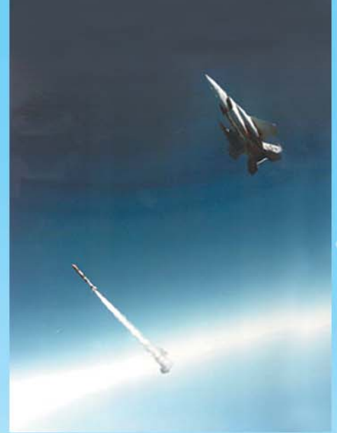
Missile antisatellite miniature américain (ALMV) lancé par un chasseur F-15, avant sa sortie de l'atmosphère.
