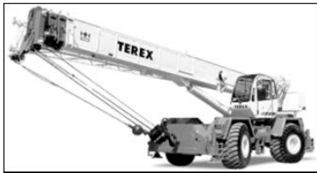
Figure 2 - Grue automotrice sur pneus de capacité moyenne
