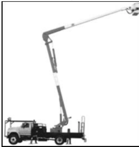
Figure 6 - Camion à nacelle (élévation multidirectionnelle)
