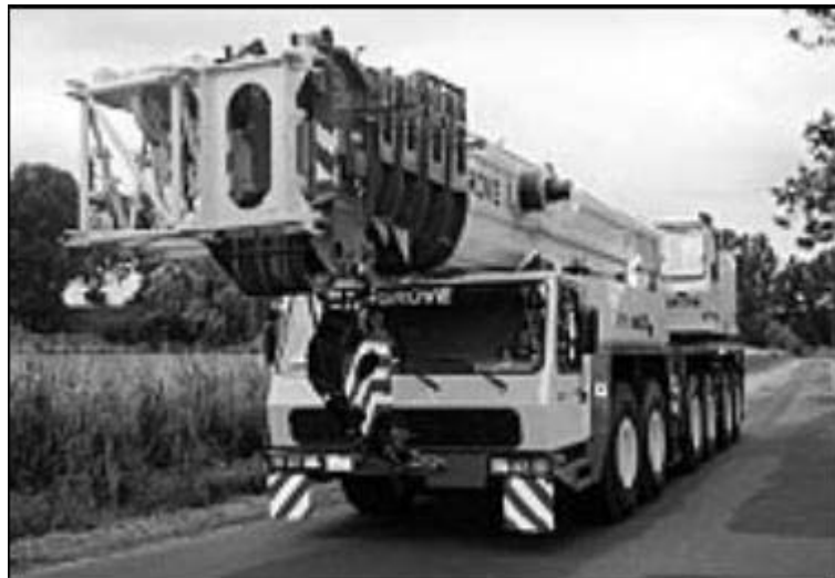
Figure 3 - Grue hydraulique sur porteur à flèche télescopique de forte capacité
