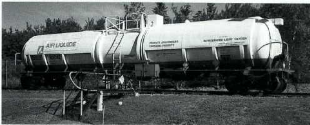
Wagon-citerne cryogénique et produit réfrigéré Ces véhicules livrent le gaz carbonique, l'oxygène, l'azote et l'argon. Le wagon-citerne cryogénique transporte un grand volume de liquide sur de longues distances.
