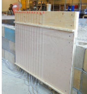
Figure 67 : Panneau de lecture des piézomètres
