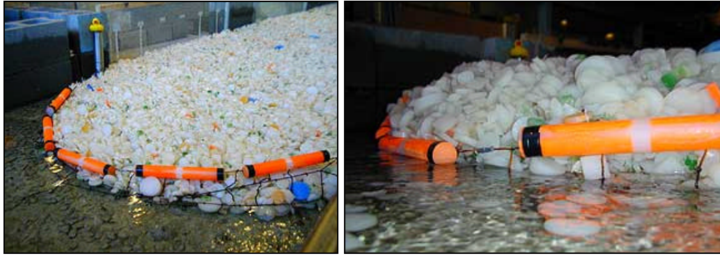
Figure 105 : Enfoncement du centre de l'estacade à des débits de 200 et 300 m 3 /s
