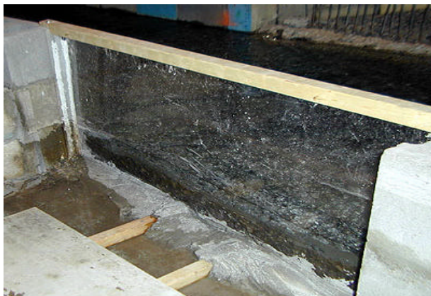
Figure 68 (a,b) : Fenêtre de plexiglas et vue d'un embâcle à travers la fenêtre
