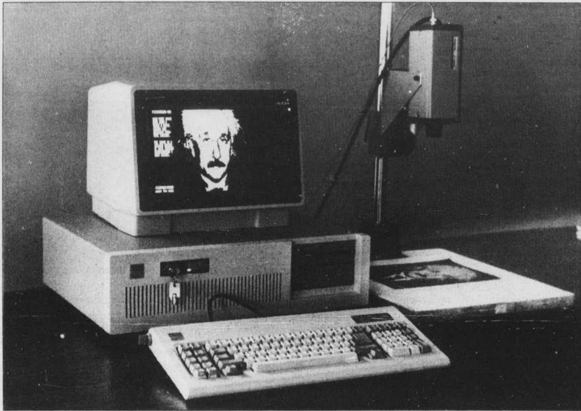
Le programme « album d'images-100 » de Coreco permet de rappeler et d'afficher des images annotées, après digitalisation, par la carte Oculus-100
