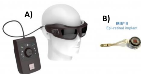
Figure 7 Aperçu du système de prothèse rétinienne IRIS II MC MC de Pixium Vision 1
